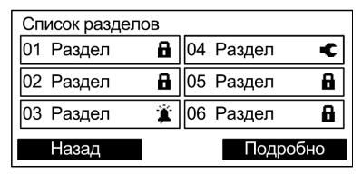
Для управления выделенной группой разделов следует нажать одну из клавиш (поставить на охрану, снять с охраны, перевзять на охрану, сбросить пожарные тревоги и неисправности) и ввести номер и код пользователя.
