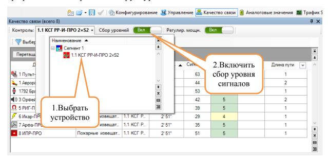
Для получения данных по качеству связи следует выбрать устройство "PP-И-ПРО 2xS2" и включить сбор уровней сигнала.
