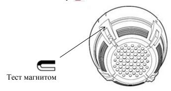
Данное действие формирует событие "Пожар2", при этом цвет иконки раздела Аврора-Д-ПРО или Аврора-ДО-ПРО становится красным. Событие "Пожар2" также будет отображаться на устройстве Пульт-РР-ПРО. В Стартовом комплекте данное событие запускает оповещение следующим образом:
