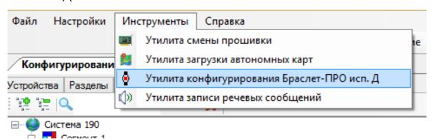
Для конфигурирования Браслет-ПРО исп. Д необходимо подключить его к ПК с помощью зарядного устройства ЗУ-1 и кабеля USB-microUSB, входящих в комплект поставки.
