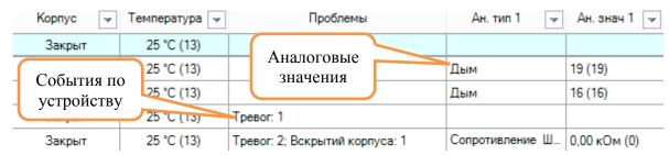
При помощи инструмента "Фильтр проблем" осуществляется сортировка тревог и неисправностей устройств по их количеству за определенный промежуток времени. Для этого необходимо нажать кнопку "Фильтр проблем" и установить временной интервал для отображения. После нажатия кнопки "Фильтровать" колонка "Проблемы" сортируется по возрастанию и убыванию.
