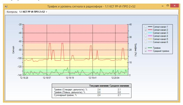
При обнаружении помех на отдельных рабочих каналах возможно изменение основного рабочего канала системы для повышения устойчивости функционирования оборудования (в окне свойств РР-И-ПРО в разделе "Конфигурирование").
