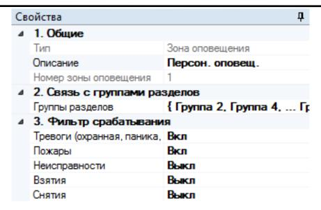
Оповещения, приходящие на Браслет-ПРО исп. Д, могут быть изменены при помощи утилиты конфигурирования, которая вызывается с помощью меню "Инструменты"  $\rightarrow$  "Утилита конфигурирования Браслет-ПРО исп. Д":
