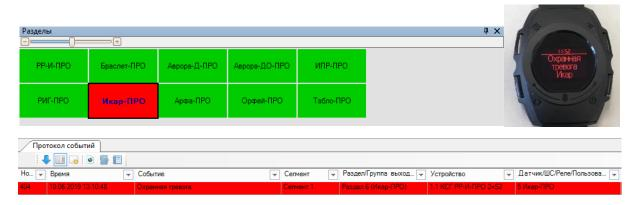
После проверки необходимо перевзять раздел под охрану (т.е. снять тревогу и повторно поставить под охрану): правой кнопкой мыши по иконке раздела → "Перевзять" на охрану. Также можно установить автоматическое перевзятие раздела на охрану через определенное время (в окне "Разделы" в разделе "Конфигурирование").
