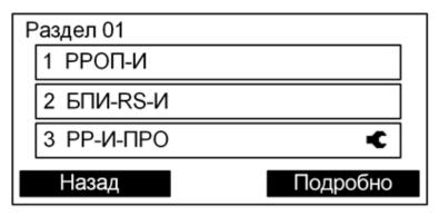
При нажатии кнопки "Подробно" открывается подробное состояние адреса (в зависимости от типа устройства отображаемая информация может быть различной).
