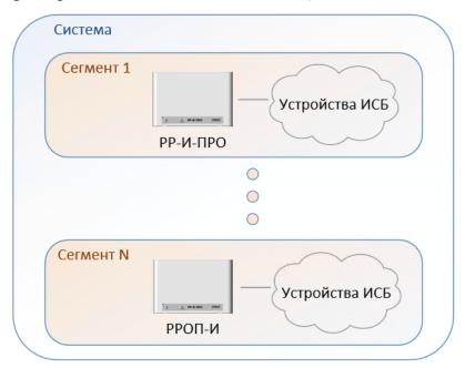
В данном стартовом комплекте система состоит из одного сегмента, а в качестве КСГ выступает устройство РР-И-ПРО.
