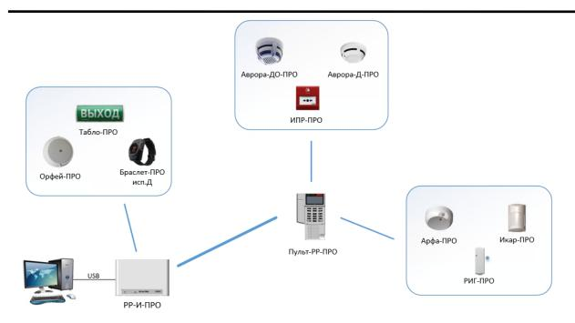
Управление устройствами обеспечивается через Пульт-РР-ПРО, либо ПК с установленным ПО Стрелец-Мастер.
