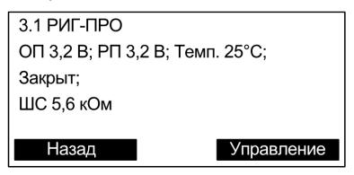
При нажатии кнопки "Управление" открывается окно управления адресом (в зависимости от типа устройства набор команд может быть различным). Управление доступно только зарегистрированным пользователям.
