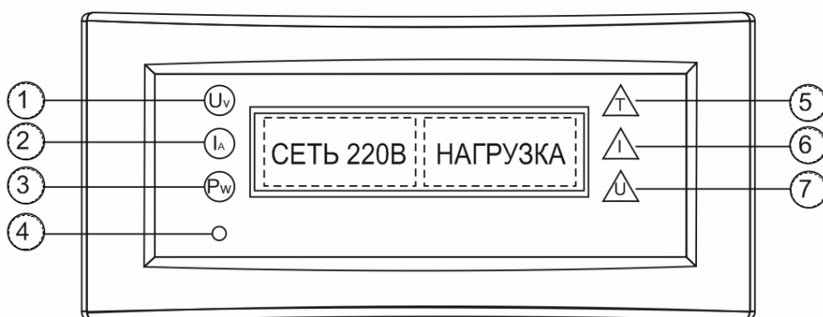
Рисунок 2 – Цифровой дисплей стабилизатора
