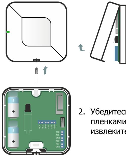
1. Вскройте корпус устройства: выкрутите фиксирующий винт и снимите крышку корпуса.
