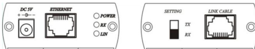
**DC 5V** – Разъем для подключения блока питания;
