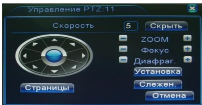
Функции камеры PTZ: контроль направления, зум, фокус, регулировка диафрагмы, патрулирование между двумя точками, контрольное патрулирование, периферийное сканирование, вспомогательный выключатель, выключатель света, уровень вращения и т. д.
