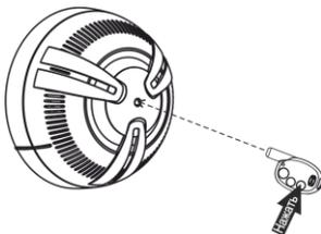
При этом у извещателя на 2 с включится индикация **красного** цвета, затем извещатель переходит в режим поиска радиосети, и **белый** индикатор извещателя мигает с частотой 5 Гц
